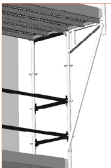
Rys. 3.28 – Rozszerzenie za pomocą wspornika 0,73 m i stężenia
