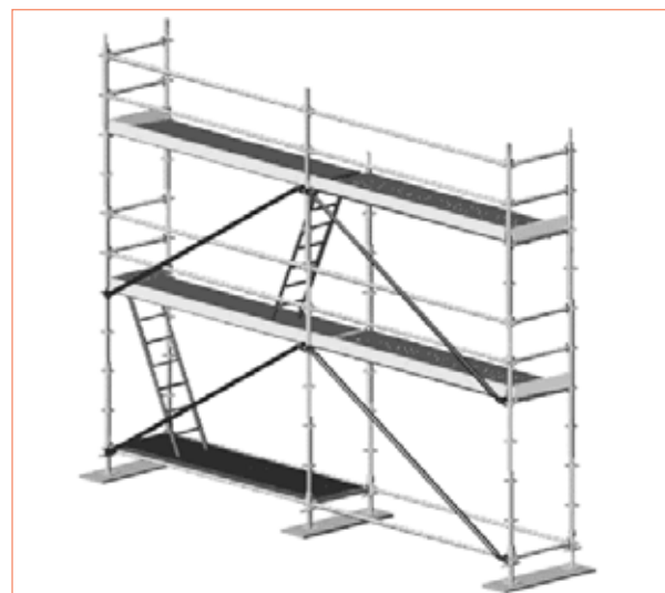
Rys. 3.23 – Przykład rusztowania z zabezpieczeniem bocznym
