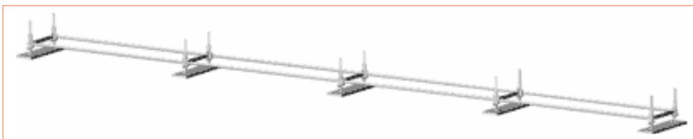
Rys. 3.54 – Etap 3 – Spinanie elementów początkowych
