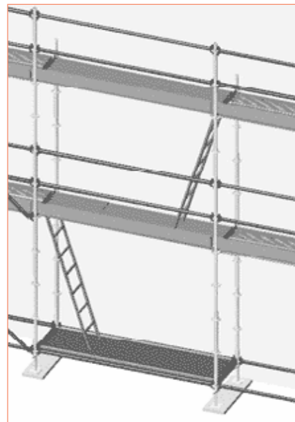
Rys. 3.41 – Wejście na rusztowanie z użyciem przejściowych pomostów aluminiowych wyposażonych w drabiny aluminiowe
