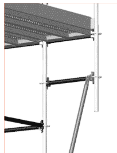
Rys. 3.29 – Rozszerzenie za pomocą rygli i stężeń
