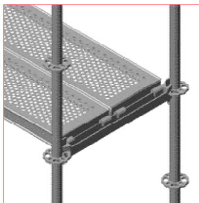
Rys. 3.18 – Etap 1 – Położyć pomosty
