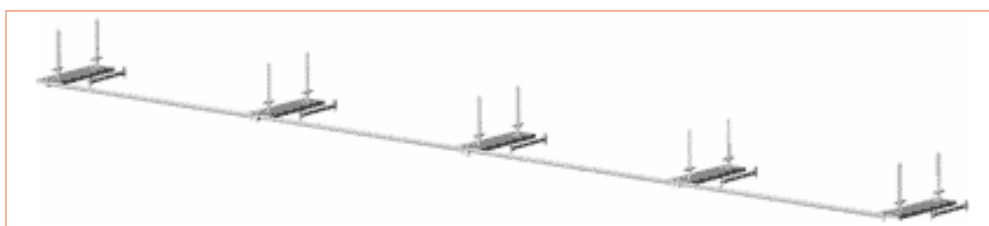
Rys. 3.52 – Etap 1 – Montaż podstawek
