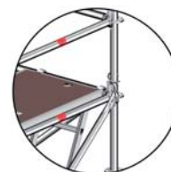
Ryc. 87: Połączenie stojaka przy pomocy zawleczeni zabezpieczającej (Nr 4000.000)
