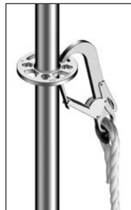
Rys. 28: Zaczepienie jest możliwe do dużego i małego otworu tarczy rozetowej
