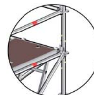
Ryc. 88: Połączenie stojaków przy pomocy przykręcanych łączników rurowych
