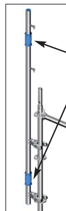
Rys. 34: Podłączenie słupka montażowego ze stojakiem
