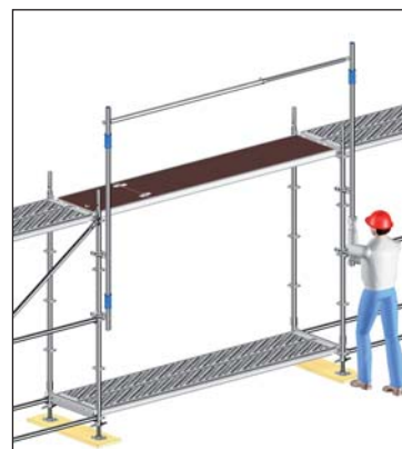
Rys. 36: Szczegół montażu ochronnej poręczy wyprzedzającej w polu z przejściem
