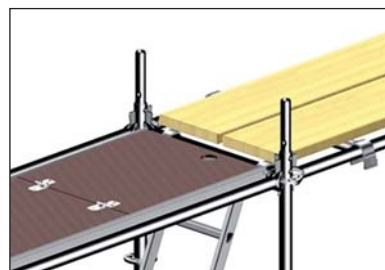
Rys. 51: Grube deski montażowe na ryglach nakładanych
